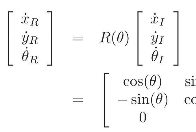
meaning that  $\dot{x}_R = \dot{x}_I \cos(\theta) + \dot{y}_I \sin(\theta) + \dot{\theta}_I 0$  $\dot{y}_R = -\dot{x}_I \sin(\theta) + \dot{y}_I \cos(\theta) + \dot{\theta}_I . 0$  $\theta_R = \dot{x}_I \cdot 0 + \dot{y}_I \cdot 0 + \theta_I \cdot 1 = \theta_I$
